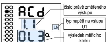
Jakmile jsou výstupy vybité, regulátor začne spínat jednotlivé výstupy jeden po druhém. Vždy po vypnutí výstupu se zobrazí zjištěná hodnota úhlu U1 - v daném příkladu hodnota 0-L3.
