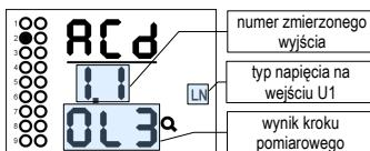
Po wyczerpaniu wyjść regulator rozpoczyna przełączanie jednego wyjścia na raz. Za każdym razem, gdy wyjście jest wyłączone, wyświetlana jest wartość kąta U1 - w tym przypadku wartość 0-L3.
