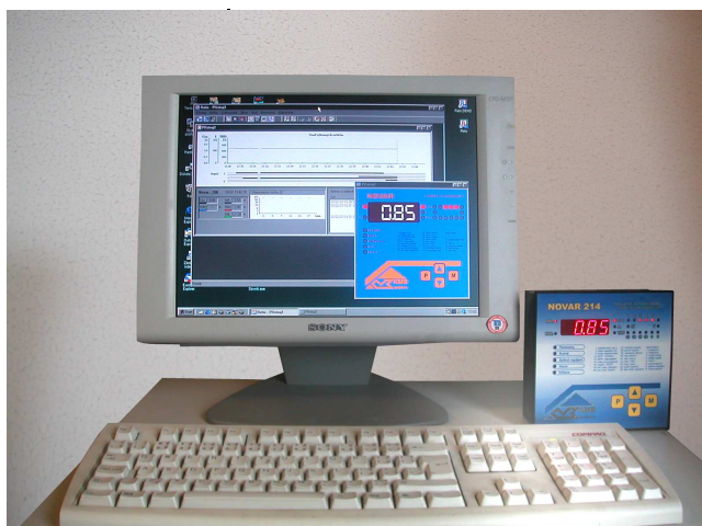
Obr. 1 : Sledování stavu regulátoru na vzdáleném PC
